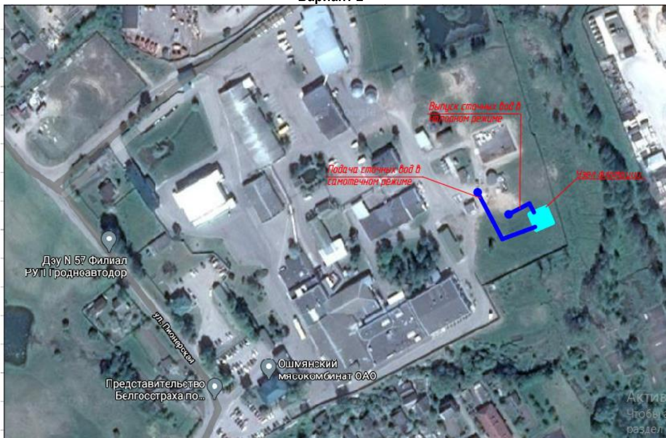
Рисунок 5. Схема очистки и выпуска сточных вод предлагается следующая: Сточные воды в самотечном режиме от трубопровода подачи сточной воды на существующую КНС подаются на узел физико-химической очистки. После очистки сточные воды в напорном режиме подаются в сети городской канализации по существующему коллектору
