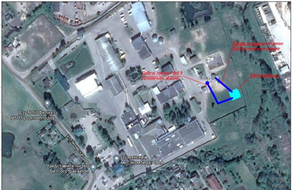
Рисунок 6. Схема очистки и выпуска сточных вод предлагается следующая: Сточные воды в самоотечном режиме от трубопровода подачи сточной воды на существующую КНС подаются на узел физико-химической очистки. После очистки сточные воды в самоотечном режиме подаются в существующую КНС и далее в гордские сети по существующей схеме
