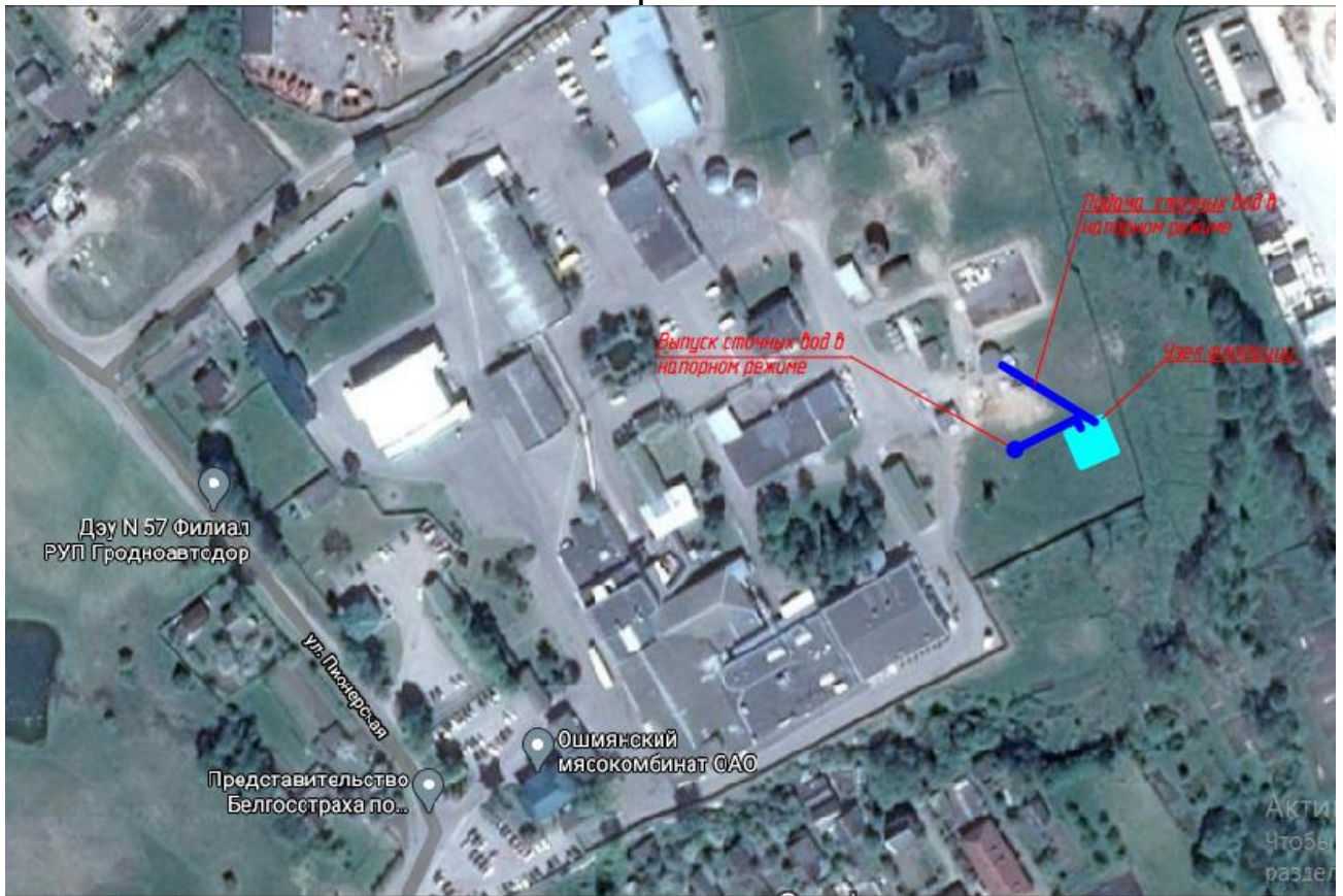
Рисунок 4. Схема очистки и выпуска сточных вод предлагается следующая: Сточные воды от существующей КНС подаются на физико-химическую очистку в напорном режиме. После очистки сточные воды в напорном режиме подаются в сети городской канализации по существующему коллектору
